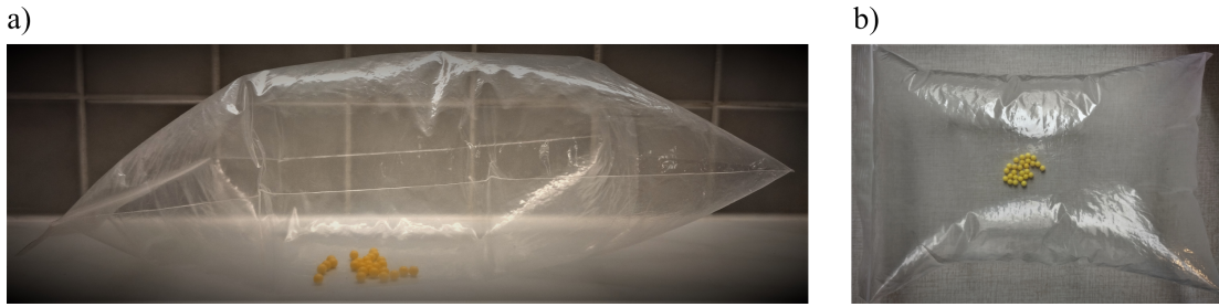
Abbildung 7.1: BB-Bag von der Seite (a) und von oben (b). Das Volumen-Verhältnis von BBs (‚baby bullets‘) und Tüte entspricht dem Verhältnis der gleichen Zahl an Luft-Molekülen und eingenommenem Volumen der Luft (Hull et al., 2023).
